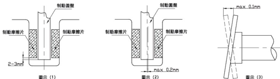
適合于水平軸或垂直軸制動方式。水平軸制動方式時，可沿制動盤周圍任意角度安裝；垂直軸制動方式時，角度不限，一個制動盤，可安裝一臺制動器，也可安裝兩臺或兩臺以上制動器，但安裝兩臺或兩臺以上時建議盡量對稱安裝。無論選擇那種安裝方式，安裝面與制動圓盤軸心都必須垂直。
